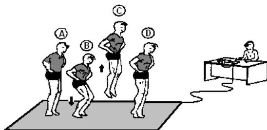
Son principe de fonctionnement est le suivant : le tapis est relié par des capteurs à un scientifique qui relève les données. Dans l'exemple ci-dessus, une représentation du CMJ (Counter Mouvement Jump), le sportif testé effectue les mouvements suivants :
